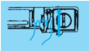
Bild 8: Die Verriegelung der Kartusche nach oben drücken
