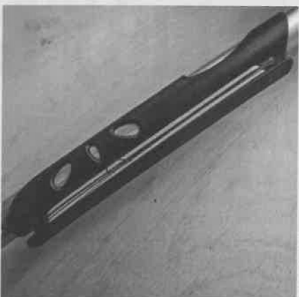
Das Wickelbrett wird auf den Rutenblank geclippt, so dass dann die Montage darauf aufgewickelt werden kann
