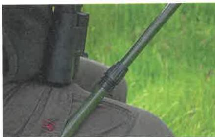
Mittels Plastikmanschetten kann die Höhe der Auflage verstellt werden.
