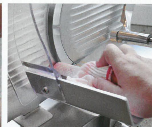
Hardcore-Test: Eine Karotte wird in den Handschuh gesteckt. Danach schneidet die Aufschnittmaschine für 5 Sekunden. Dieser Belastung hielt kein Schnittschutzhandschuh stand
