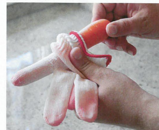
Hardcore-Test: Eine Karotte wird in den Handschuh gesteckt. Danach schneidet die Aufschnittmaschine für 5 Sekunden. Dieser Belastung hielt kein Schnittschutzhandschuh stand
