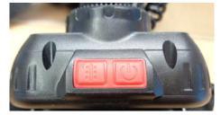
Mit dem Schlater wird sie durch einmaliges Drücken eingeschaltet. Beim ersten Drücken der Taste leuchtet die Doppel-COB LED. Nach dem zweiten Drücken der Taste leuchtet die rote LED und nach dem dritten Drücken der Taste ist der rote LED Blinkmodus eingeschaltet, beim vierten Drücken ist die Lampe wieder ausgeschaltet.
