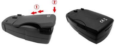
5- Drücken Sie den Deckel leicht an, bis Sie ein Klickgeräusch hören.
